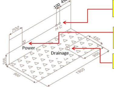
Elektroanschluss: 230V / 3.00 KW / 1 Meter Kabel lose mit AP-Verteilerdose, Absicherung 16 Amp. über Fl
