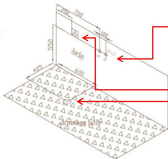
**Wasseranschlüsse mit Absperrventil und Doppelnippel 1/2 Zoll (Aussengewinde)**
